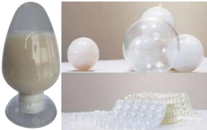
纳米吸能材料是由非浸润纳米多孔材料、功能流体、改性剂经过特殊工艺制备而成。无外力时功能流体分子无法进入其纳米孔洞，当外力作用（冲击、碰撞）压强大于临界渗入压强时，功能流体被迫进入纳米孔洞中，将外界动能快速转化为固-液界面能和摩擦热能，实现能量的高效吸收。该材料具有吸能密度高、可重复、性能可调、阻燃、抗静电的性能优势，可广泛应用于道路交通、航空航天、个人防护、汽车安全等领域
